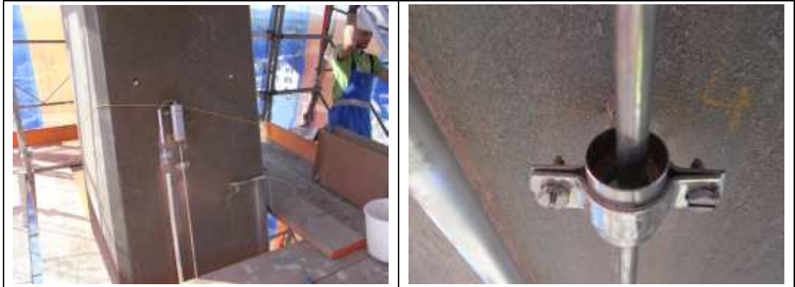
Abb. 3.24 Links: Oberes Ende des MagX-Extensometers und rechts: Positionsmagnet (Messmarke) des MagX-Extensometers.
